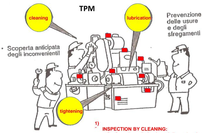
Prevenzione della caduta e degli allentamenti di bulloni Complete elimination of dirt and stains, especially in the main parts of the systems.
