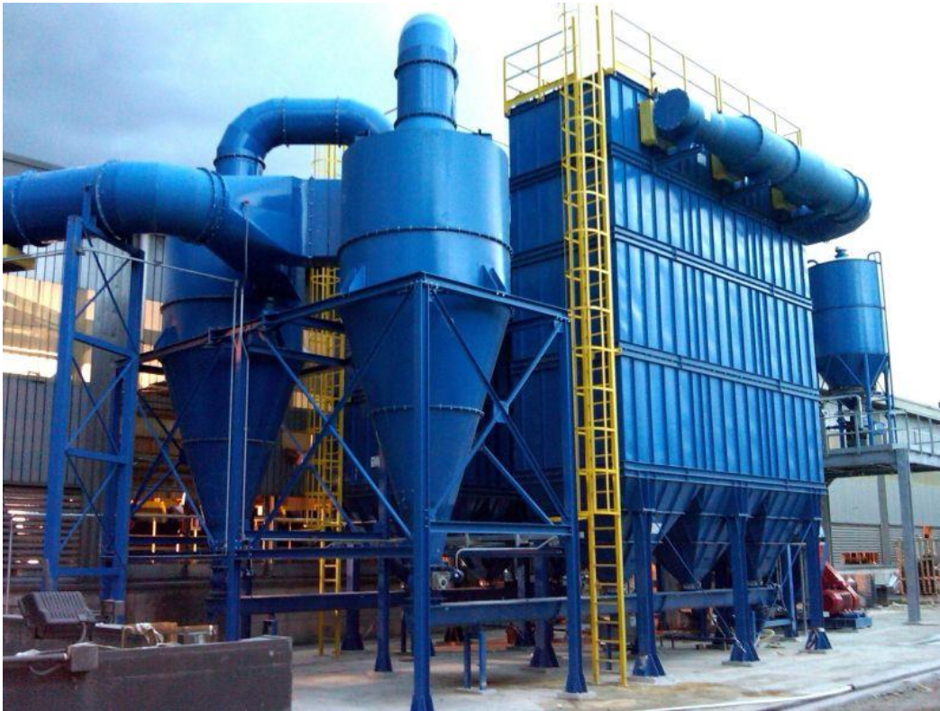
Figura 82 Dispositivo di abbattimento polveri per impiego nell'industria siderurgica. Si notano due cicloni in parallelo seguiti da filtro a maniche.
