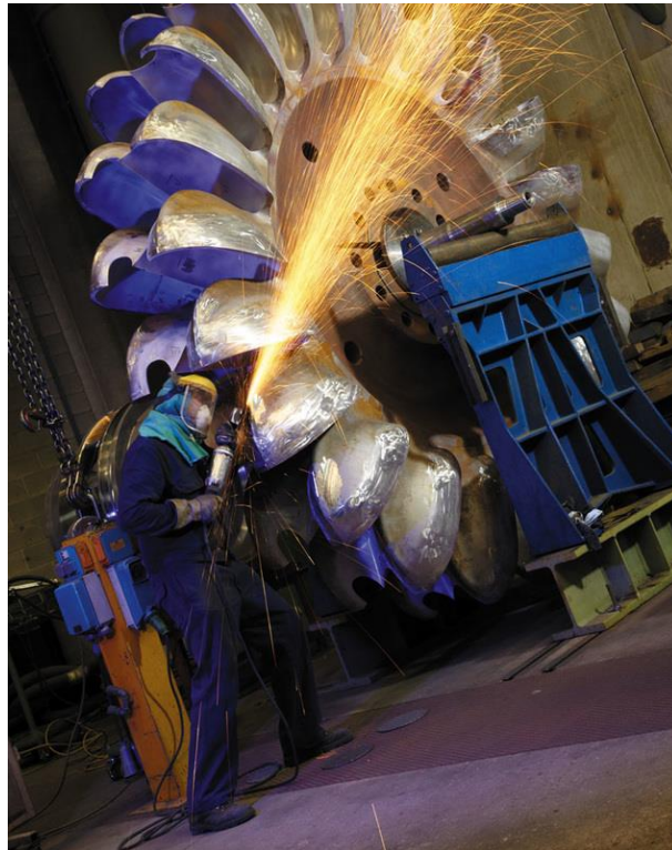
Figura 11 Particolato metallico emesso ad elevata velocità durante un'operazione di smerigliatura
