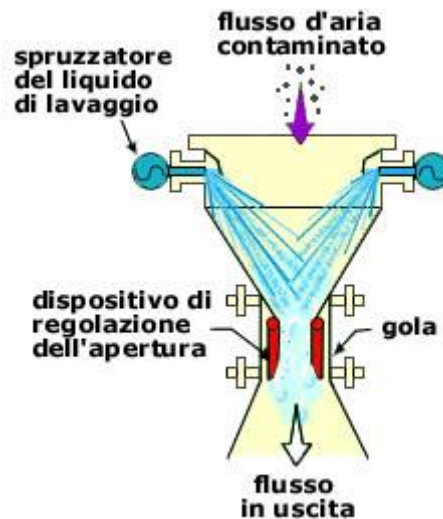
Figura 92 Depuratore Venturi – Principio di funzionamento
