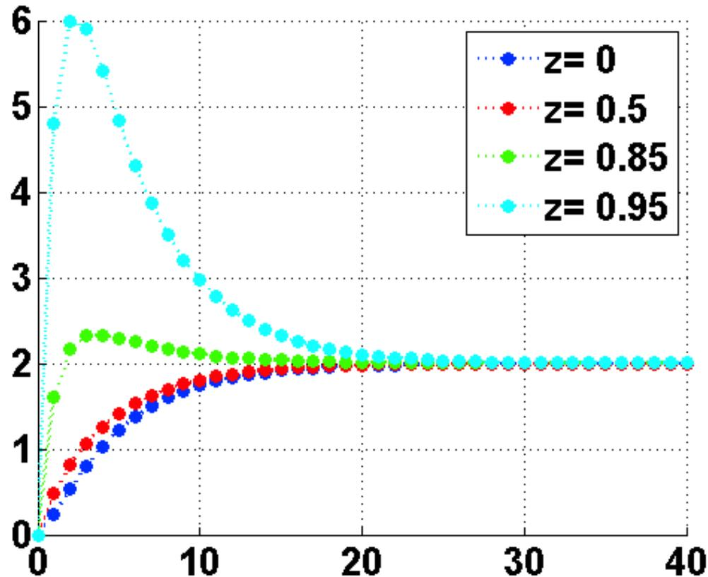
Risposta allo scalino del sistema del 2° ordine, al variare della posizione dello zero.
