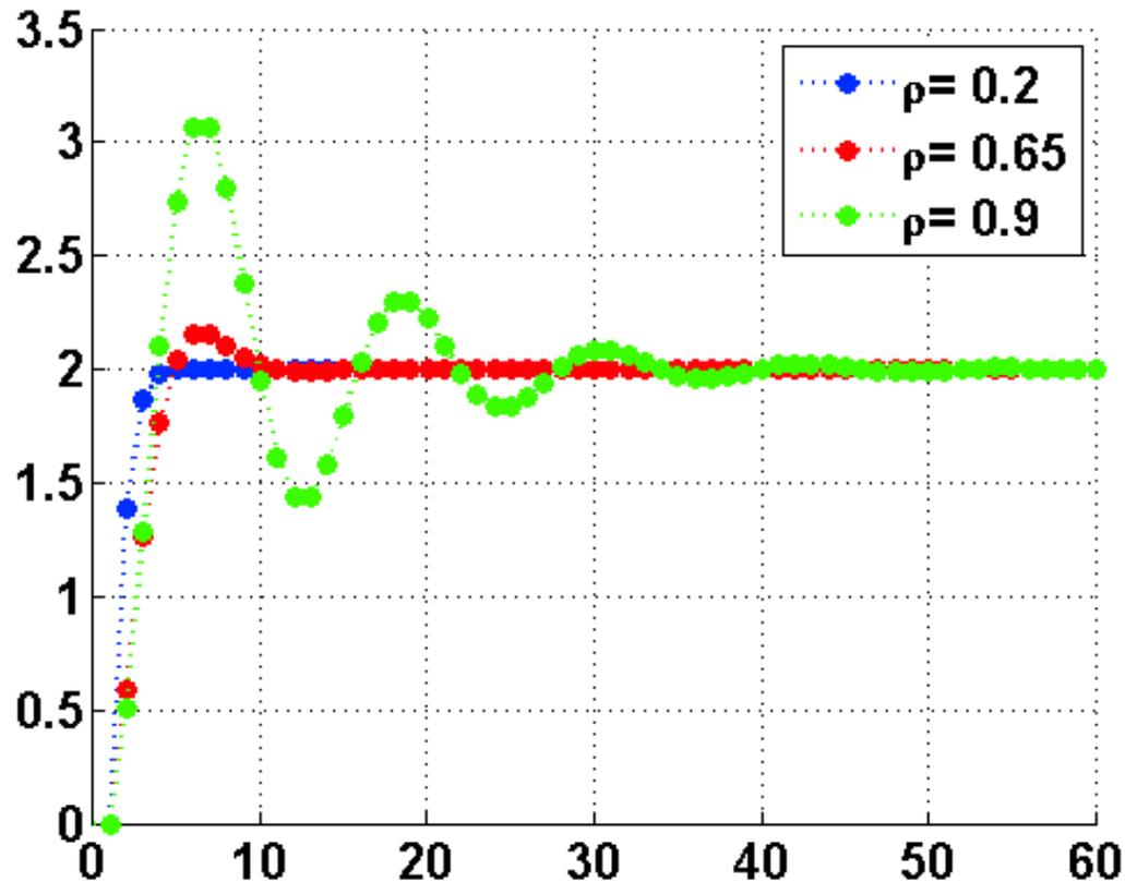
Risposta allo scalino del sistema del 2° ordine, con due poli complessi coniugati, al variare del modulo dei poli  $\rho$ .
