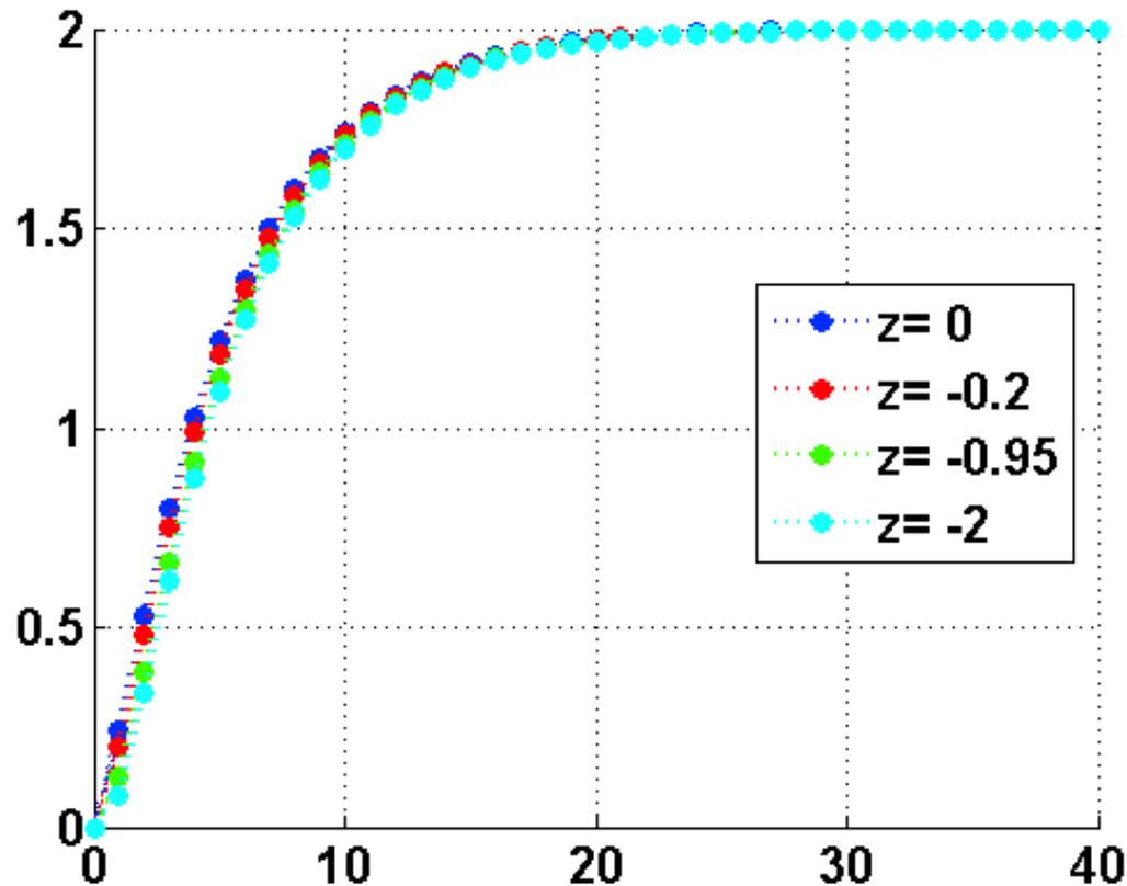
Risposta allo scalino del sistema del 2° ordine, al variare della posizione dello zero.
