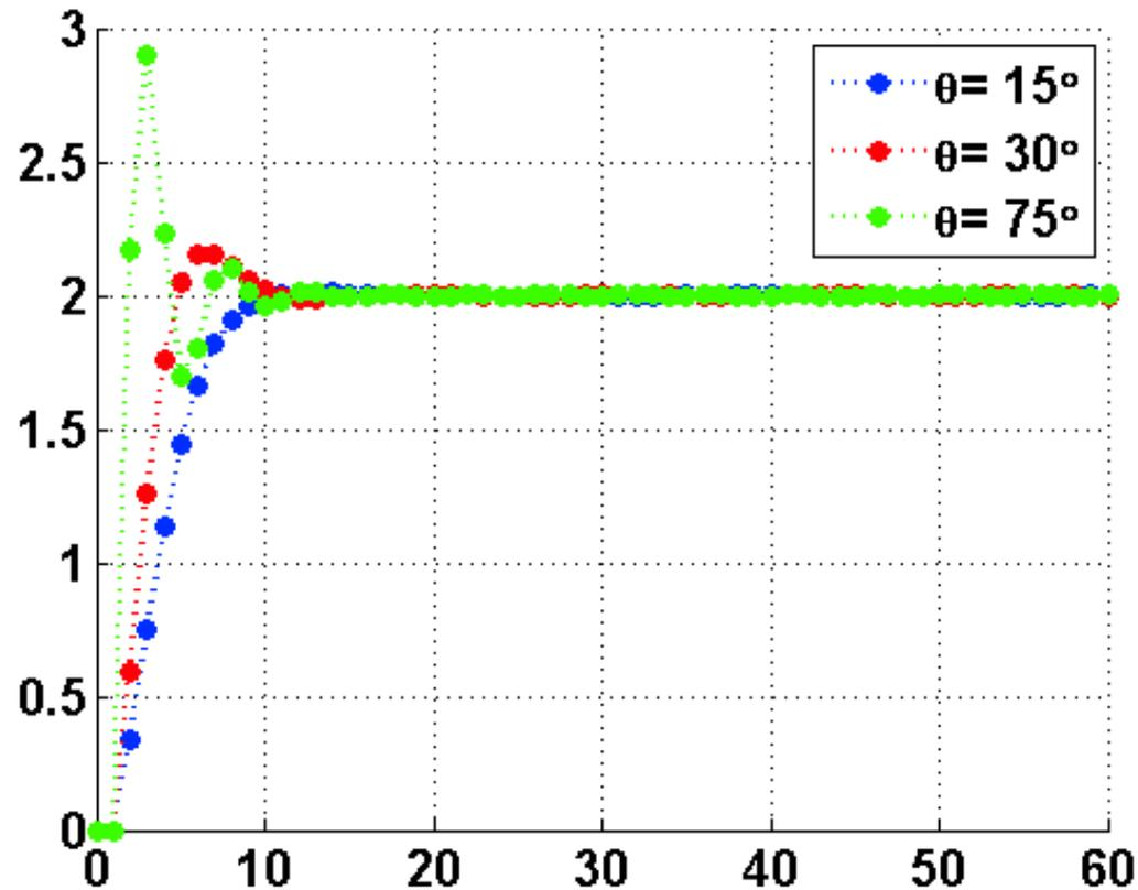
Risposta allo scalino del sistema del 2° ordine, con due poli complessi coniugati, al variare della fase dei poli  $\theta$ .
