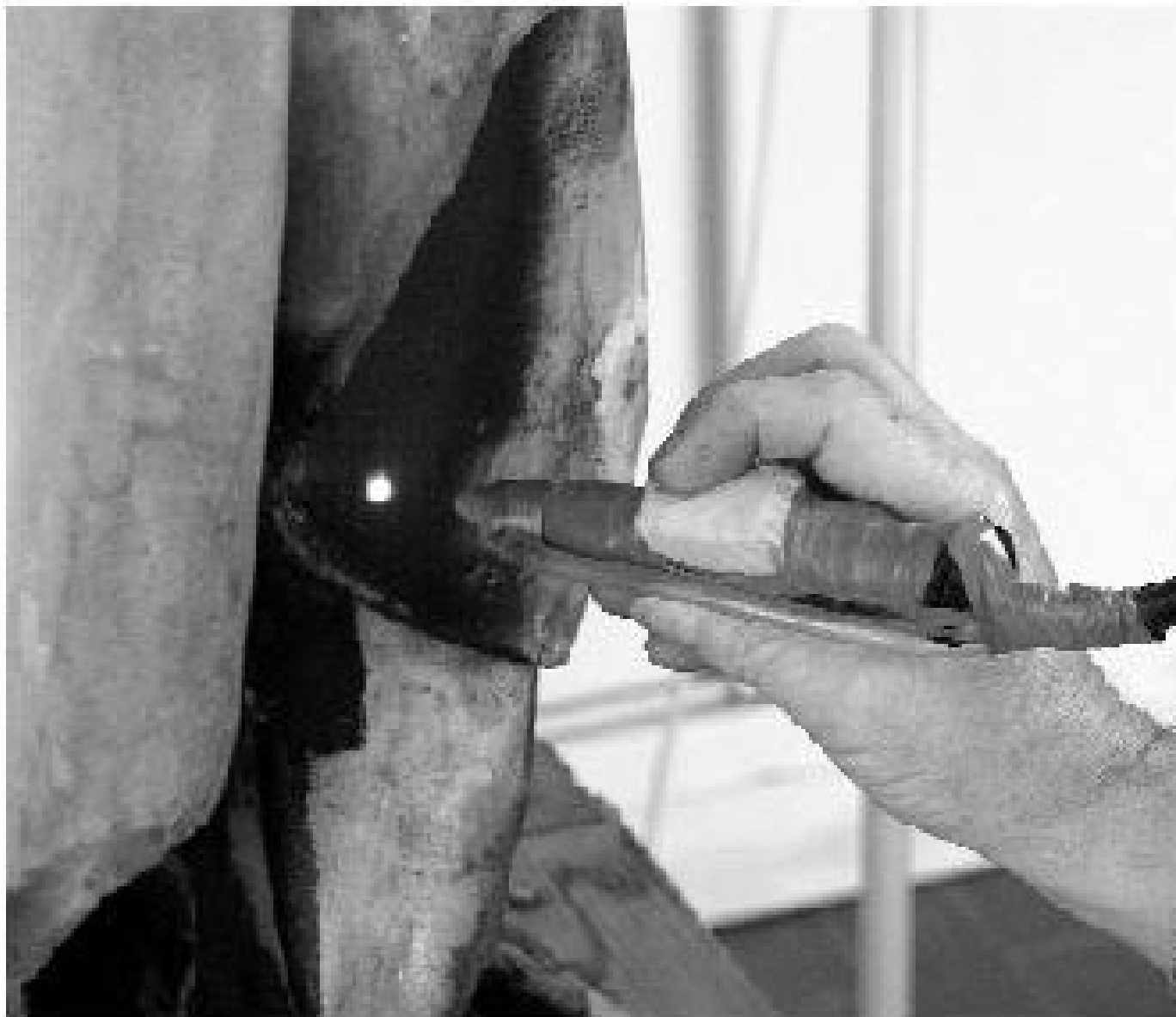
Figura 6 • In uscita, viene spesso introdotta una lente di focalizzazione, allo scopo di ottenere spot di diverse dimensioni, in funzione della distanza dalla superficie irraggiata.
