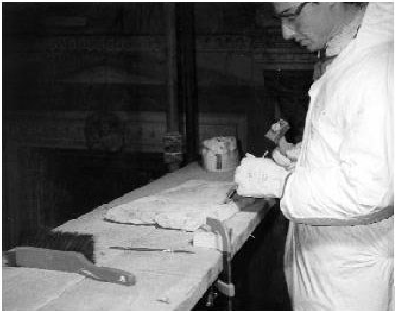
Figura 5 • Pulitura, in laboratorio, di una lastra di marmo.
