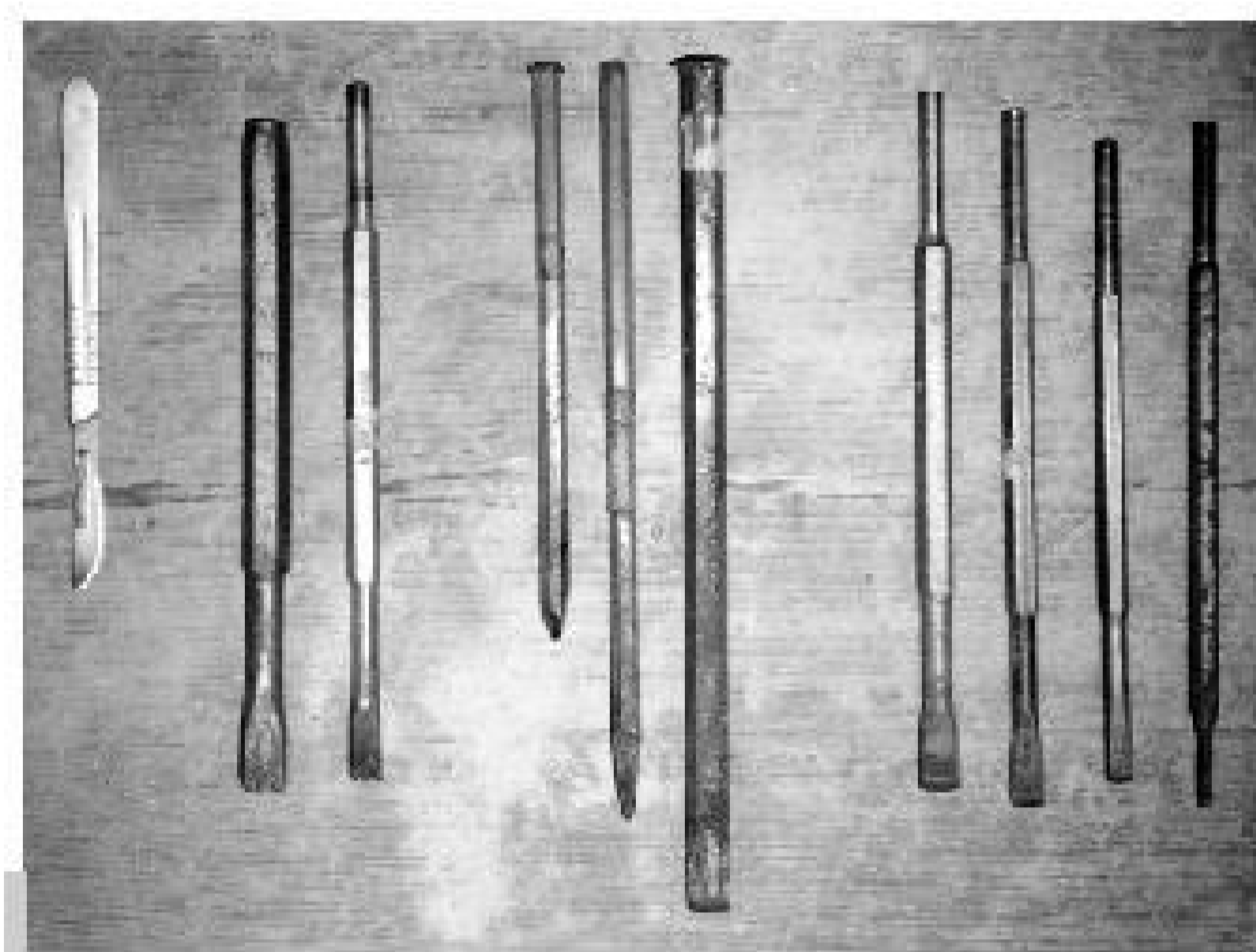
Figura 6 • Tra gli utensili a punta ne sono compresi anche di grandi dimensioni, a lama, a punta, a scalpello e a taglio dentato.
