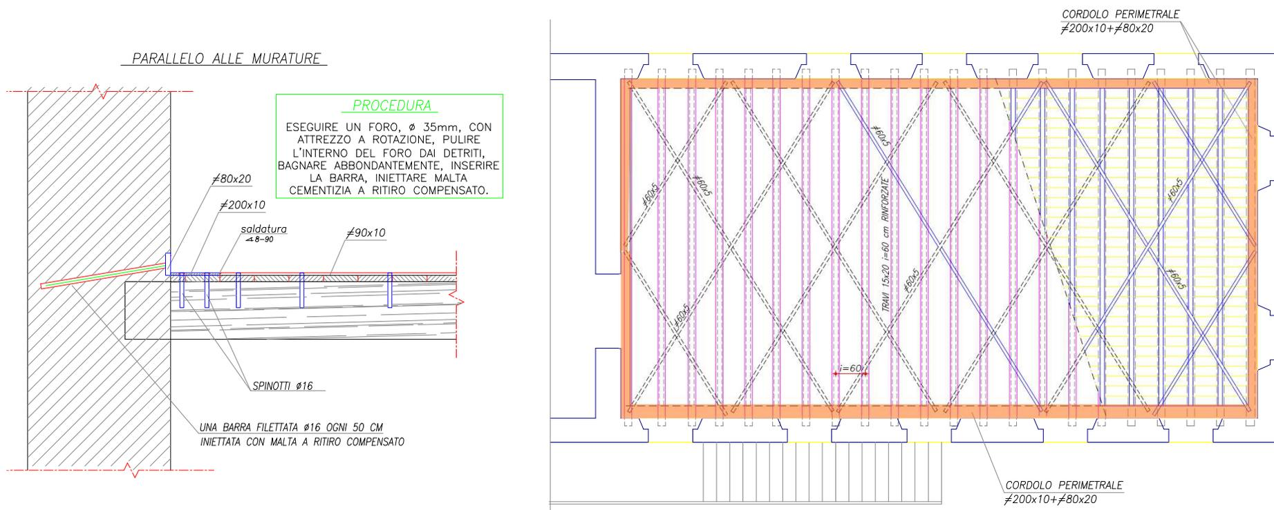
**Profilati perimetrali a L solidarizzati sia alle travi del solaio che alla muratura con barre iniettate. Diagonali in acciaio che vanno a formare, assieme alle travi di legno e ai correnti metallici, una struttura reticolare orizzontale.**
