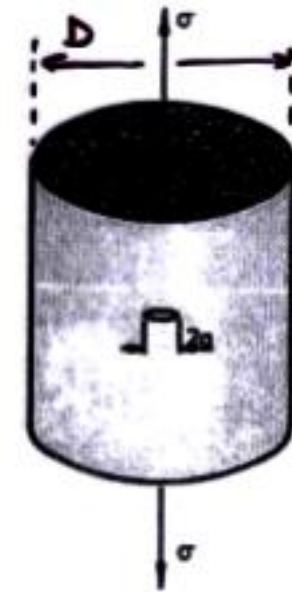
(d) internal penny crack
