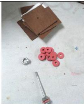
Fig. 10: materiale per i SA: lamelle di faesite grezza, un perno, guarnizioni di stanziatrici di gomma e un golfaro
