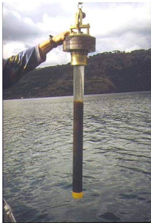
Fig. 17. Il "carotatore" è lo strumento utilizzato per il prelievo di sedimento di fondo di spessore variabile da poche decine di centimetri ad oltre un metro
