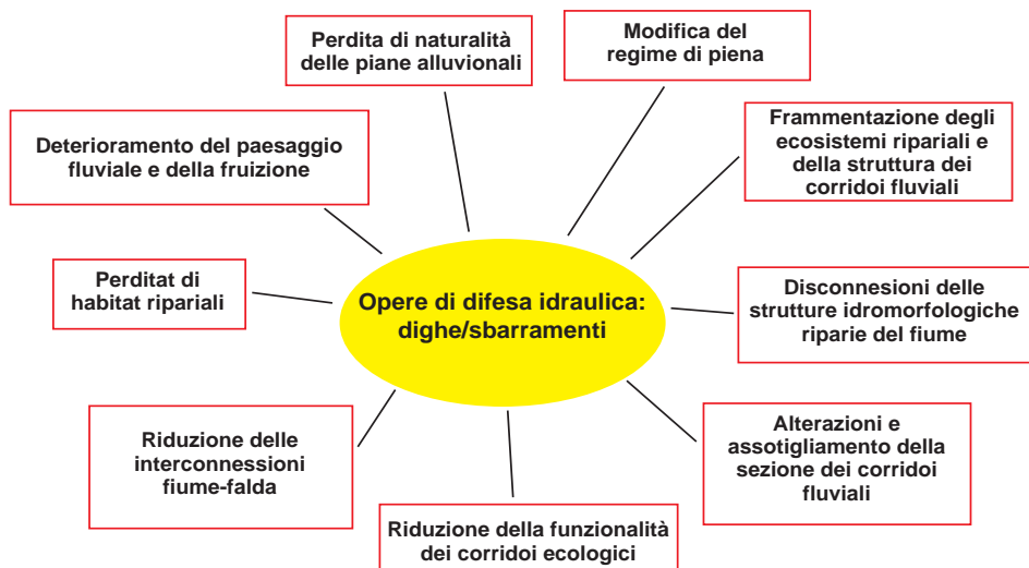
Fig. 2.17 Schema degli effetti derivanti dalle opere di difesa idraulica (da EU CIS, 2006).
