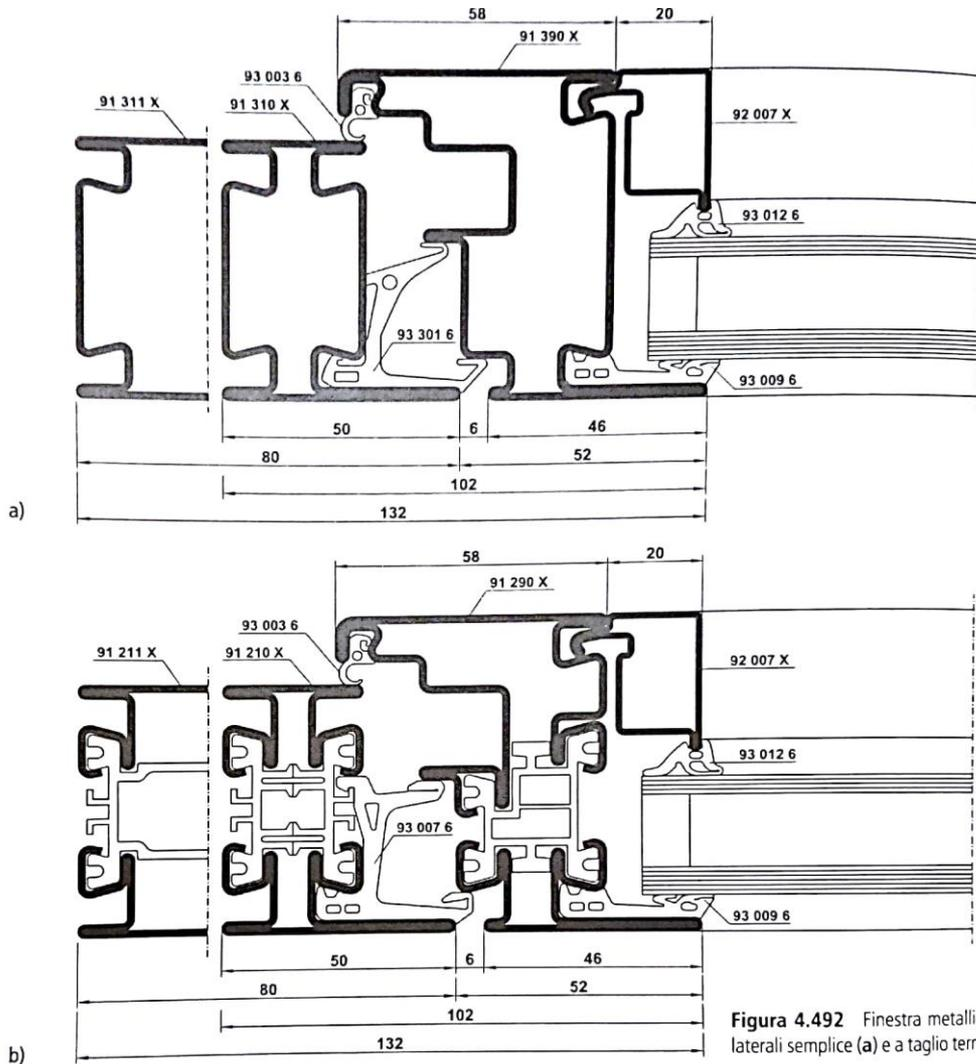
Figura 4.492 Finestra metallica: nodi laterali semplice (a) e a taglio termico (b).
