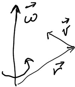
$$\left( \text{Forza di Coriolis} \quad \vec{F}_c = -2m \vec{\omega} \times \vec{v} \right)$$
