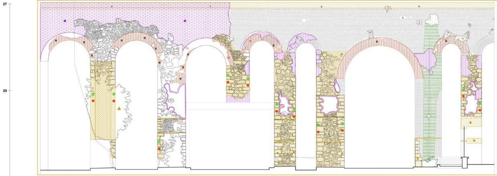
TRATTO I VIALE CASTRENSE PROSPETTO OVEST: DEGRADO E PROGETTO
