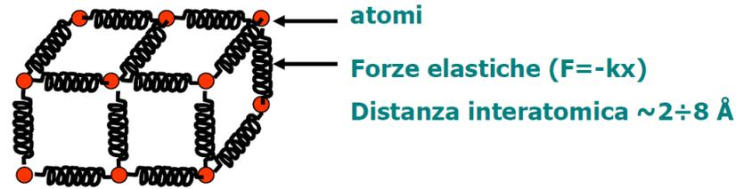
Ogni atomo è legato agli altri da forze elastiche e può vibrare intorno alla posizione di riposo. L'energia di ogni atomo, nel sistema di riferimento in cui il centro di massa del solido è fermo, vale:
