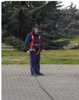
« **Maschera e tubazione di collegamento all'APVR isolante.** La tubazione permette un raggio di azione intorno ai 50 metri. Consente l'impiego simultaneo di due addetti
