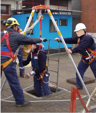
« **Recupero operatore non collaborante** con treppiede dotato di dispositivo di evacuazione e recupero
