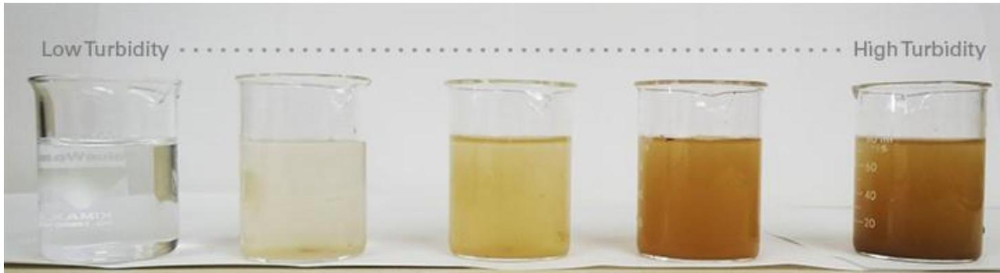
Si misura per via spettrofotometrica con il nefelometro:
