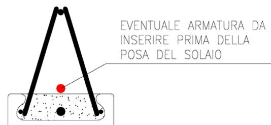
**Il travetto tralicciato è un prodotto a magazzino** e per le varie tipologie di armature vengono proposte le lunghezze di produzione riportate in apposite tabelle.
