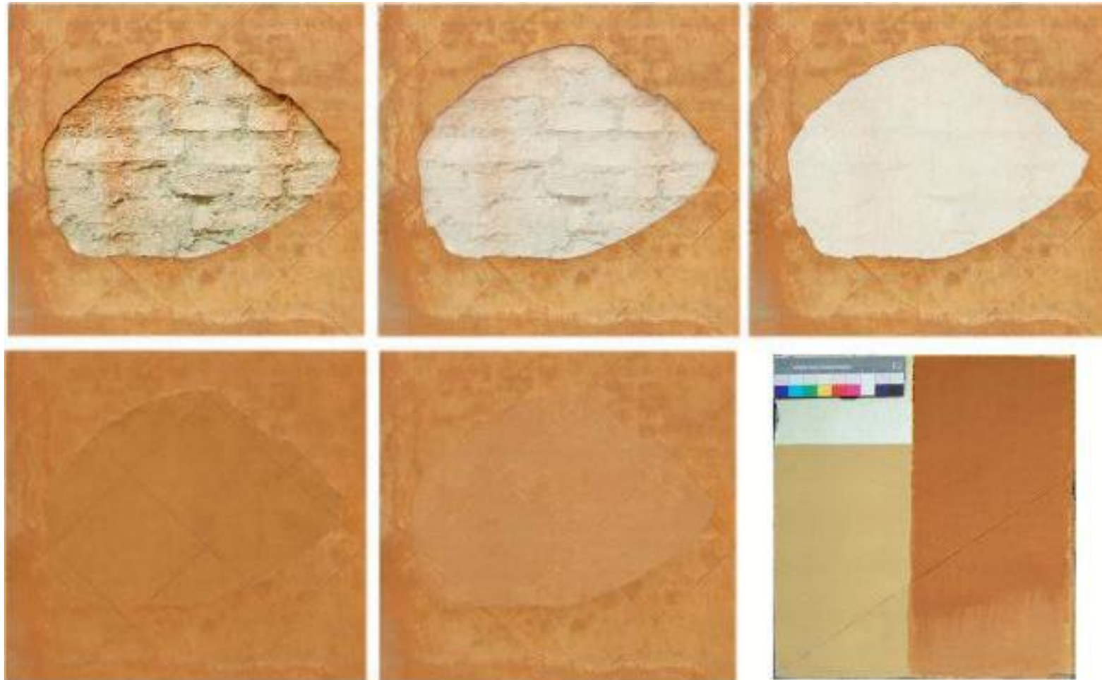
Figura 11 • Simulazione della integrazione della lacuna con le finiture importate dal pannello in basso a destra e realizzate in base allo studio cromatico della facciata. Da sinistra in alto: riquadro con la lacuna di intonaco; stesura di uno “strato non strato”; integrazione con intonaco steso leggermente sottolivello; velatura realizzata con due stesure a pennello di ocre rossa sullo sfondo di ocre gialla (parte alta della fascia rossa del pannello); velatura realizzata con una stesura a pennello di ocre rossa sullo sfondo di ocre gialla (parte in basso più chiara della fascia rossa). Negli ultimi due casi è stata simulata l’incisione del motivo a rombi e una leggera velatura rossa dell’intonaco originale.
