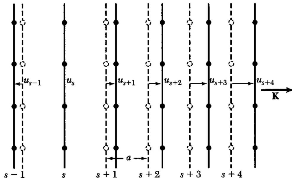
A differenza della fisica molecolare qui abbiamo un cristallo «infinito» con condizioni al contorno periodiche e quindi delle eccitazioni vibrazionali possono essere propaganti (al contrario nelle molecole erano localizzati spazialmente)
