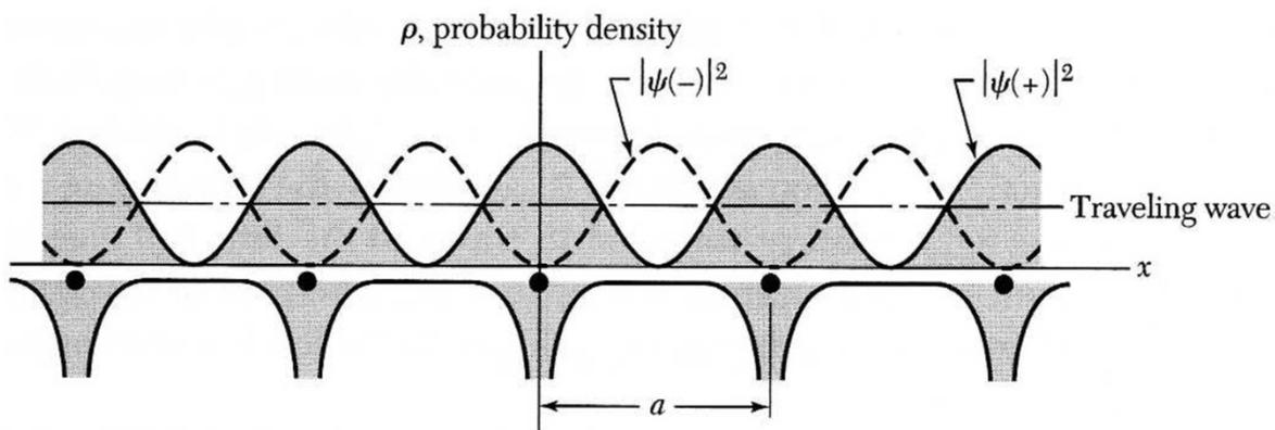
Le due standing wave hanno diversa interazione coulombiana con il potenziale dei nuclei e la gap  $E_g$  corrisponde (approx.) alla componente di Fourier del potenziale cristallino.
