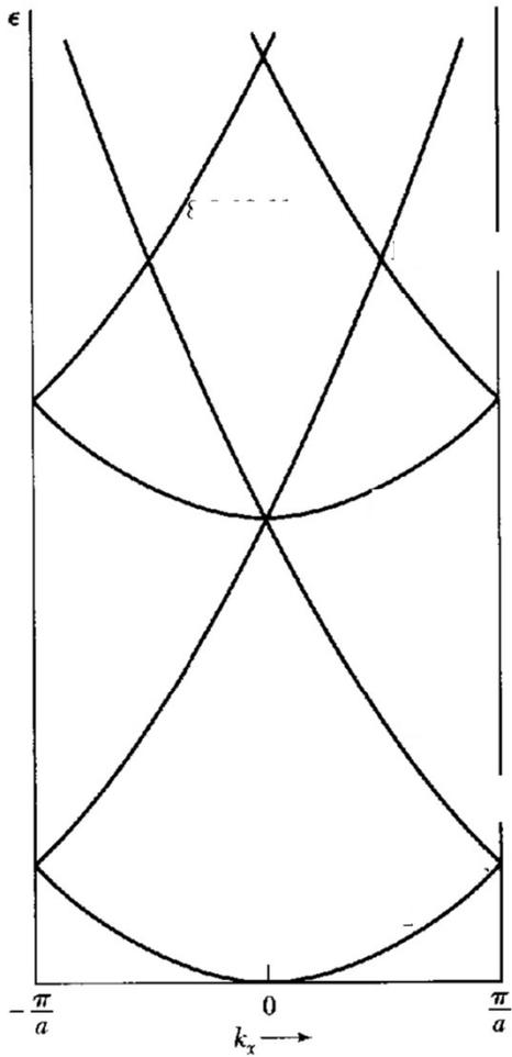
Struttura a bande per un elettrone libero in un reticolo cristallino mappata nella prima zona di Brillouin
