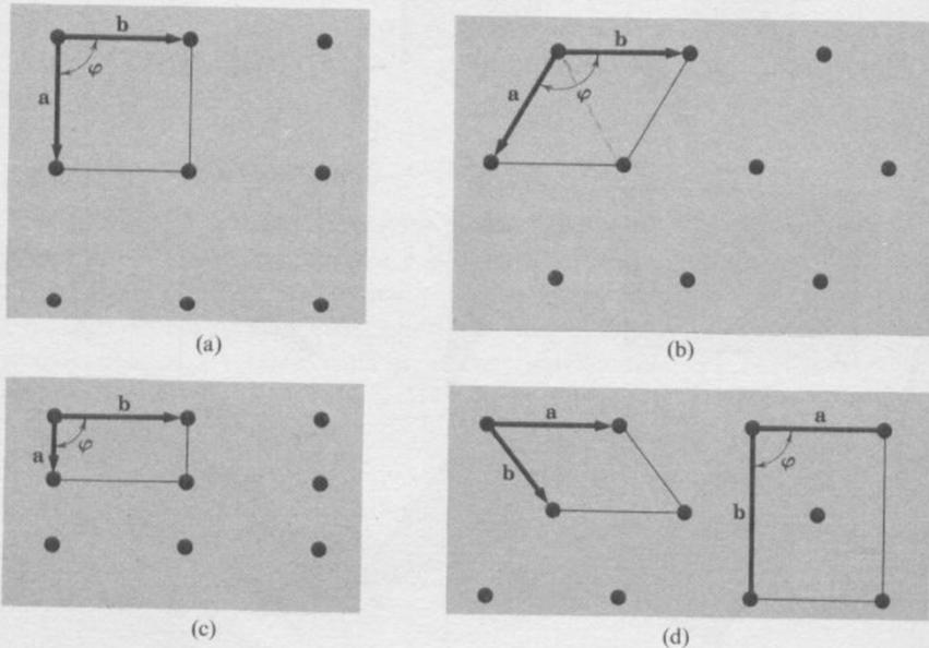
**Figura 13** (a) Reticolo quadrato:  $|\mathbf{a}| = |\mathbf{b}|$ ,  $\varphi = 90^\circ$ ; (b) reticolo esagonale:  $|\mathbf{a}| = |\mathbf{b}|$ ,  $\varphi = 120^\circ$ ; (c) reticolo rettangolare:  $|\mathbf{a}| \neq |\mathbf{b}|$ ,  $\varphi = 90^\circ$ ; (d) reticolo rettangolare centrato, sono indicati gli assi della cella primitiva e quelli della cella unitaria rettangolare, per cui  $|\mathbf{a}| \neq |\mathbf{b}|$ ,  $\varphi = 90^\circ$ .
