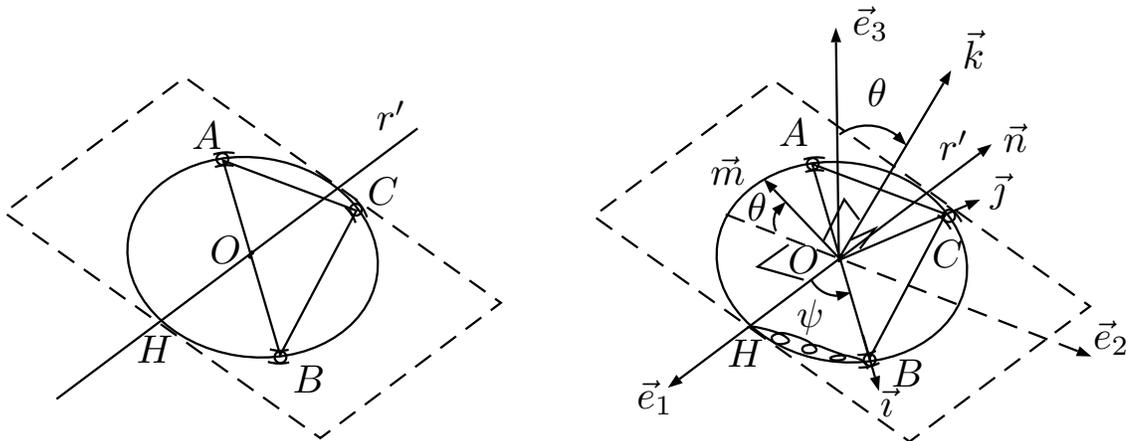
Il telaio suddetto è vincolato, mediante tre appoggi lisci e bilateri nei vertici  $A$ ,  $B$ ,  $C$ , a scorrere all'interno di una guida circolare, di raggio  $R$  e massa trascurabile. Tale guida, a sua volta, è vincolata a ruotare intorno ad un asse fisso orizzontale  $r'$  passante per il centro della guida. Il telaio è soggetto al peso proprio e all'azione di una molla di costante elastica  $c$ , fissata in  $H$  e nel vertice  $B$ .
