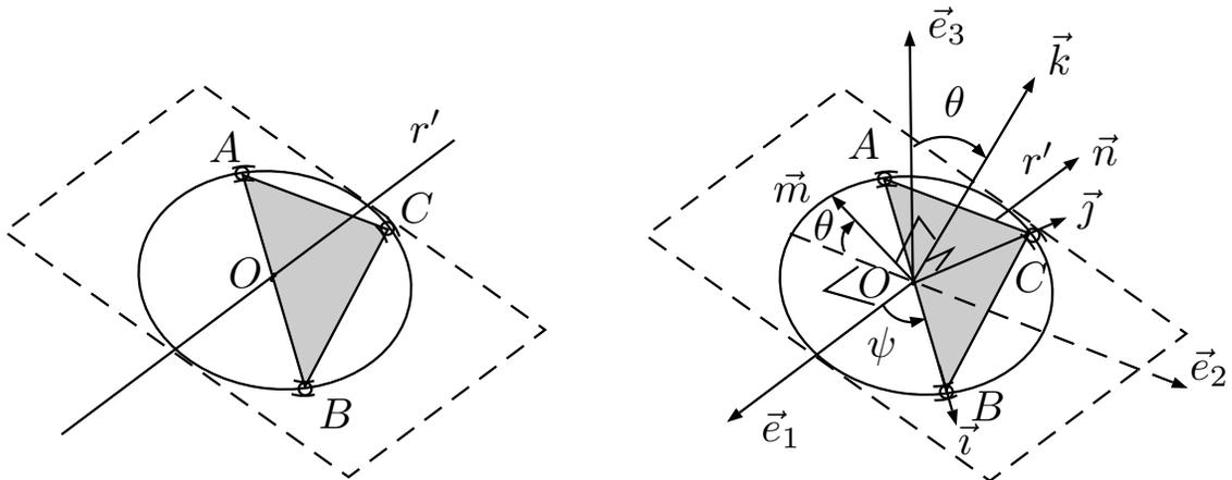
La lamina suddetta è vincolata, mediante tre appoggi lisci e bilateri nei vertici  $A$ ,  $B$ ,  $C$ , a scorrere all'interno di una guida circolare, di raggio  $R$  e massa trascurabile. Tale guida, a sua volta, è vincolata a ruotare intorno ad un asse fisso orizzontale  $r'$  passante per il centro della guida.
