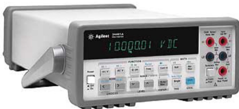
Figura 1.19: Multimetro digitale da tavolo
