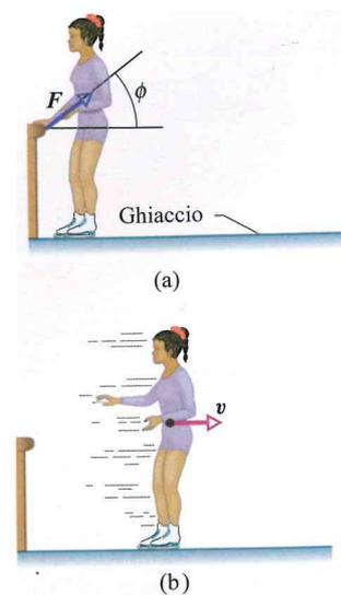
La spinta contro il parapetto trasforma l'energia interna della pattinatrice in energia cinetica
