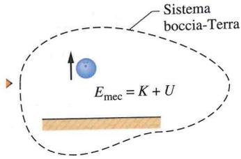
Figura 8.12 Sul sistema costituito da una boccia e dalla Terra, un lavoro positivo  $L$  provoca una variazione  $\Delta E_{mec}$  dell'energia meccanica del sistema, una variazione  $\Delta K$  dell'energia cinetica della boccia e una variazione  $\Delta U$  dell'energia potenziale gravitazionale del sistema.
