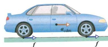
**Figura 8.16** Un'automobile a quattro ruote motrici accelera verso destra con partenza da fermo. La strada esercita quattro forze di attrito (due soltanto sono visibili nella figura) sulla parte inferiore degli pneumatici. Queste quattro forze, nel loro insieme, costituiscono la forza esterna netta  $F$  che agisce sull'auto.
