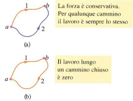
Figura 8.4 (a) Una particella soggetta all'azione di una forza conservativa parte da  $a$  e raggiunge il punto  $b$  seguendo uno dei due percorsi disponibili, 1 o 2. (b) La particella percorre un circuito chiuso: parte da  $a$ , arriva a  $b$  per il cammino 1 e ritorna in  $a$  percorrendo il cammino 2.
