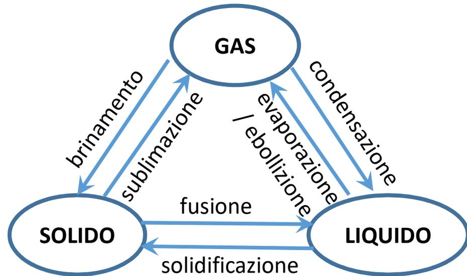
In particolari condizioni, un solido può passare direttamente allo stato gassoso. In questo caso il passaggio di stato (solido → gas) viene detto **sublimazione**. Il passaggio di stato opposto (gas → solido) viene chiamato **brinamento**.
