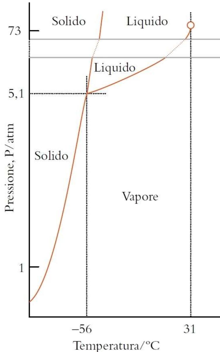
Nel diagramma di stato del biossido di carbonio, il punto triplo si trova a **5.1 atm** e ad una temperatura di **217 K (-56°C)**: alla pressione atmosferica, il biossido di carbonio non può essere mai liquefatto (ghiaccio secco).
