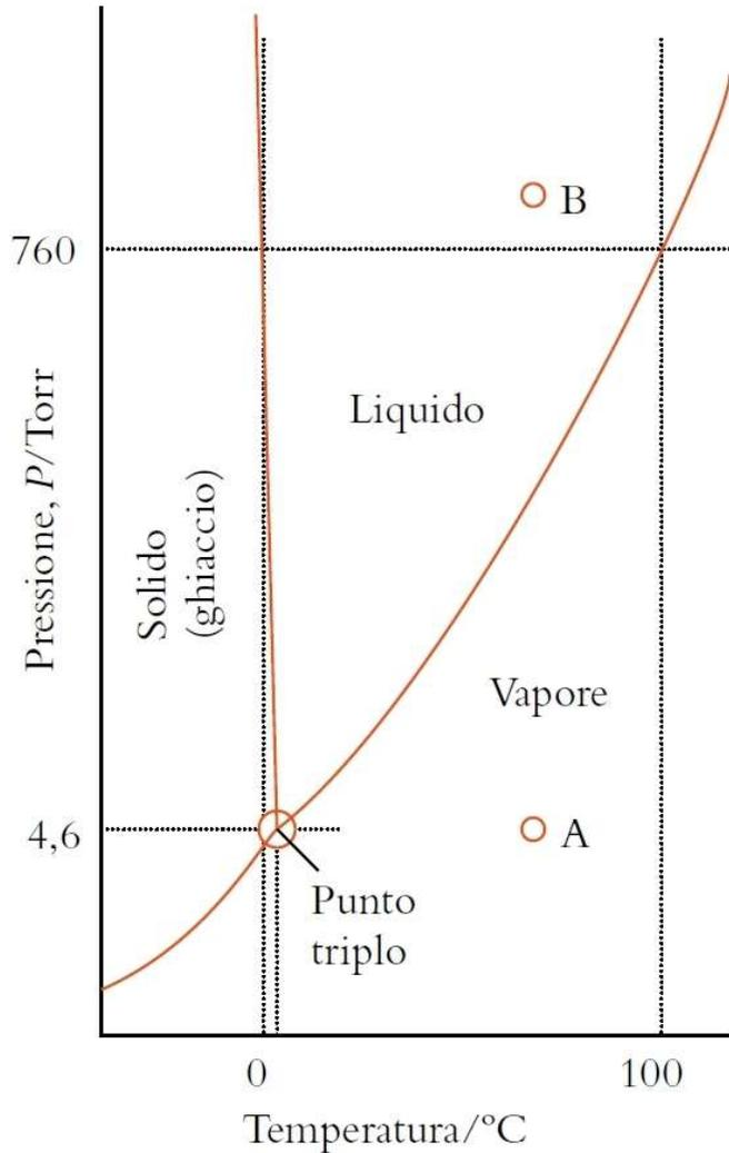
Per l'acqua il punto triplo si trova a **4.6 mmHg** e alla temperatura di **0.01 $^{\circ}\text{C}$** .
