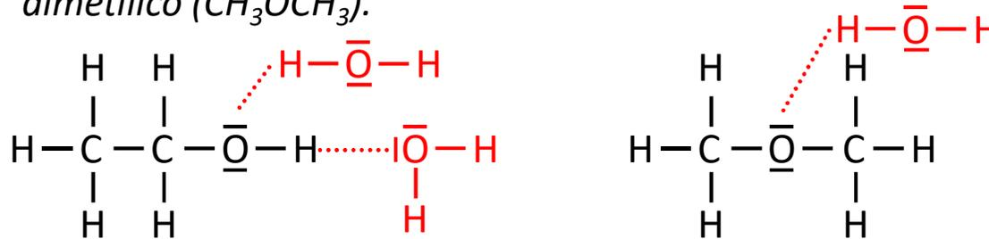
Etanolo e etere dimetilico sono isomeri strutturali: sono cioè formati dagli stessi atomi, ma organizzati nello spazio in modo diverso. L'etanolo è in grado di formare più legami a idrogeno con l'acqua rispetto all'etere dimetilico. Per questa ragione l'etanolo è maggiormente solubile in acqua rispetto all'etere dimetilico.
