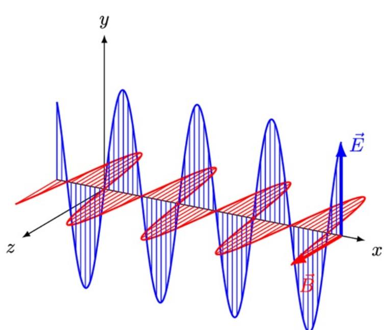
$\vec{E}, \vec{B}, \vec{k}$  formano una terna di vettori ortogonali, l'onda si propaga in direzione  $\hat{k}$
