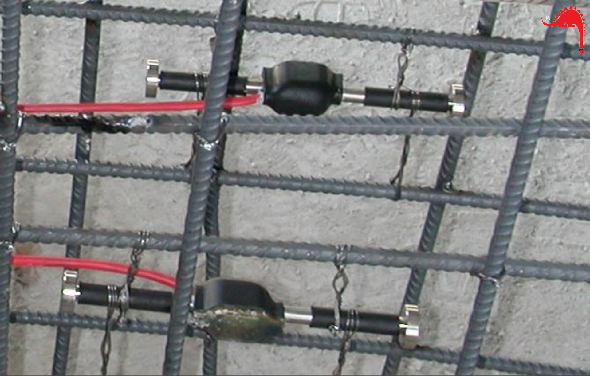
Estensimetri a corda vibrante pronti per essere annegati nel rivestimento definitivo
