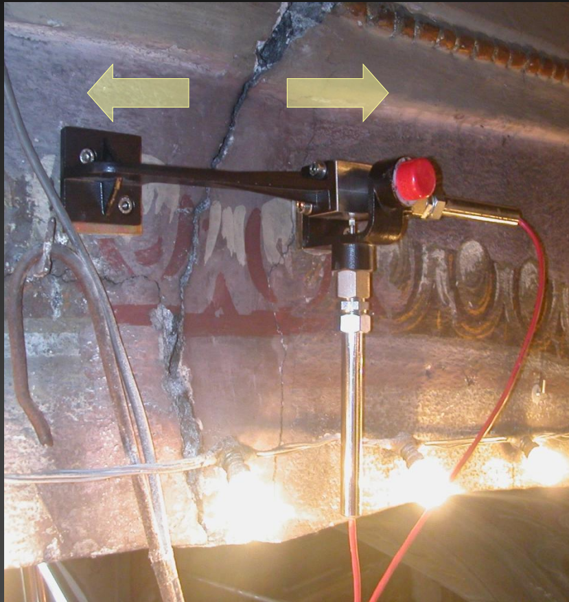
Fessurimetro elettrico 2D
