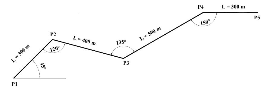
In figura è indicata la poligonale d'asse di una strada di tipo C1; supponendo che nel punto iniziale "P1" la velocità di progetto sia 80 km/h e nel punto finale "P5" sia di 90 km/h, progettare planimetricamente le curve circolari e le curve di transizione verificando il diagramma di velocità e le distanze di visibilità, supponendo gli ostacoli laterali ai margini della piattaforma. I raggi delle curve devono avere raggio diverso.
