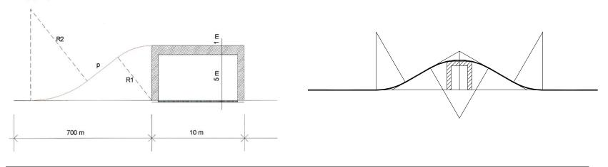
Si dimensioni il raccordo verticale convesso, per le livellette di figura, e si effettui il suo tracciamento per punti. Strada di Tipo "A", velocità di progetto del tratto 120 km/h
