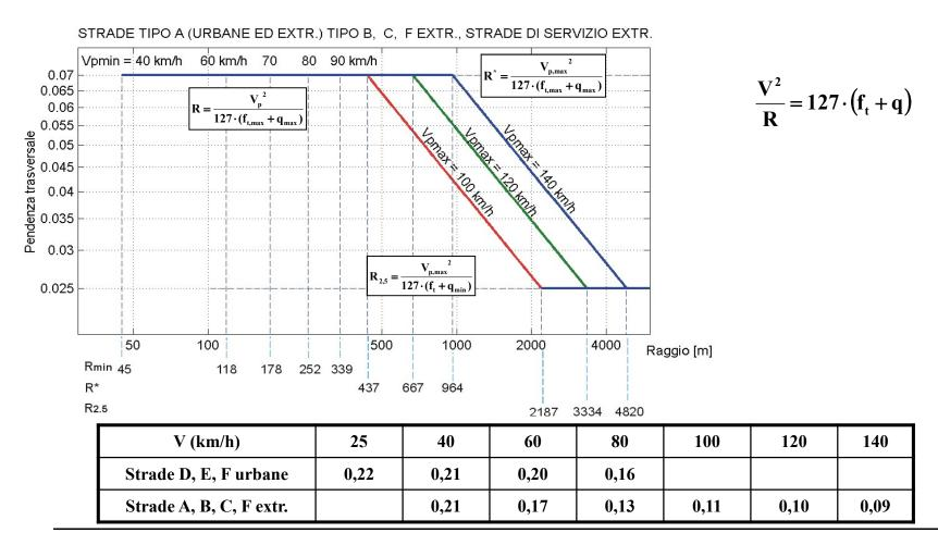
Si consideri una strada di tipo C, nell'ipotesi di raccordo tra rettifilo e curva circolare (con velocità di progetto 90 km/h), con angolo di deviazione tra i rettilinei di appoggio di 90°, si richiede : il raggio della curva, il calcolo del parametro delle clotoidi, il tracciamento per punti delle clotoidi (si ipotizzi parametri delle clotoidi in entrata e uscita differenti).
