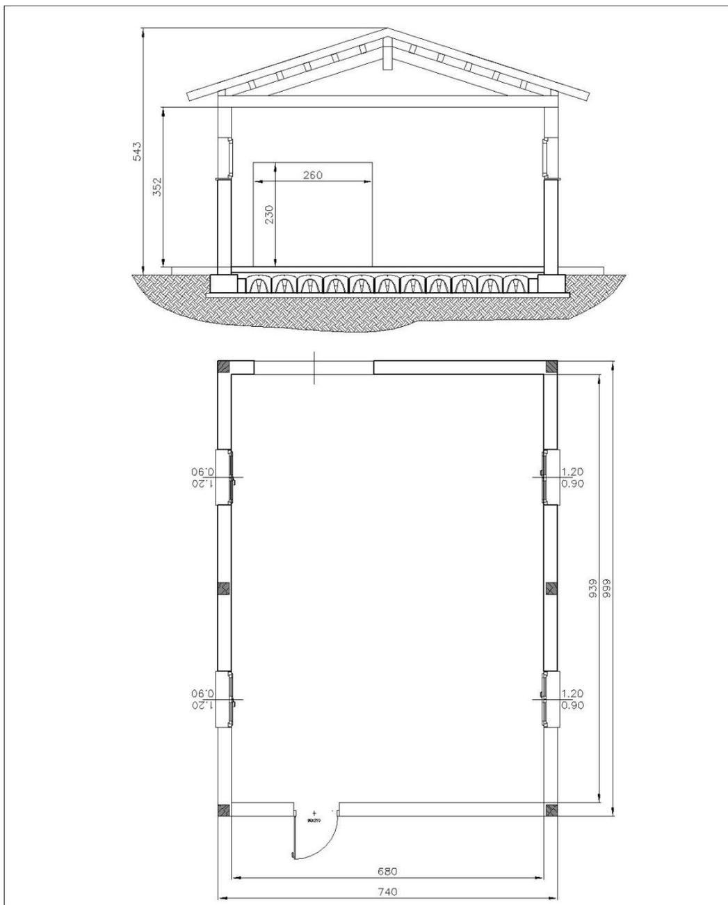
Figura 1 Planimetria e sezione del fabbricato
