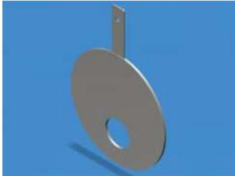
Impiegato in applicazioni in cui i fluidi possono avere solidi in sospensione, in caso di gas contenente liquidi e in caso di misura su tubazione orizzontale. Geometria di costruzione opposta (alto-basso) applicata su liquidi con gas (alto) o liquidi con solidi (basso).
