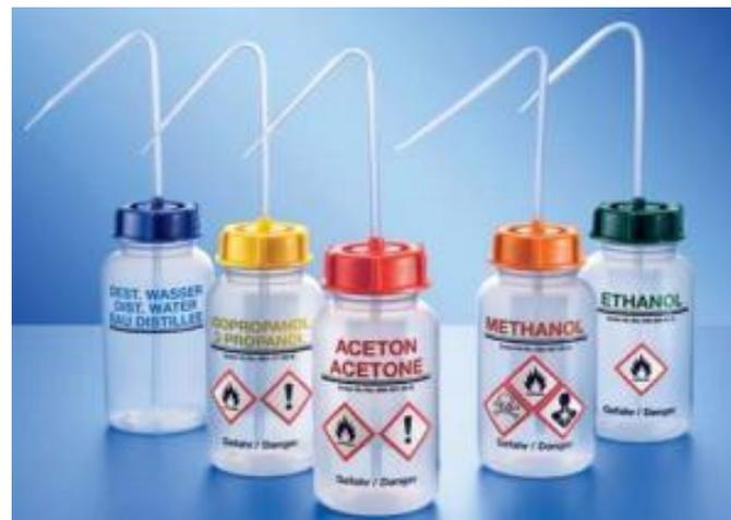
Le spruzzette vengono utilizzate per lavare la vetreria. Contengono in genere acqua distillata e acetone.
