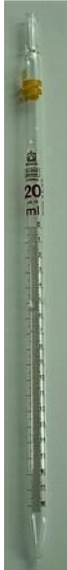
Utilizzati per la misura di volumi precisi
