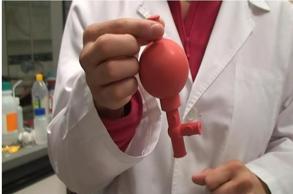
1. Svuotare il palloncino della propipetta premendo con una mano sul palloncino e con l'altra sulla valvola A
