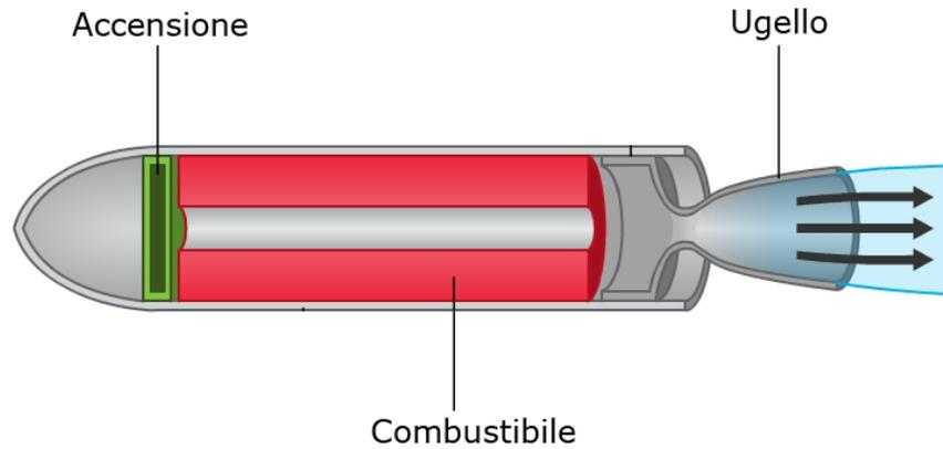
Motore a razzo: macchina dinamica termica motrice, ma non è una macchina a fluido in quanto assenti organi mobili.
