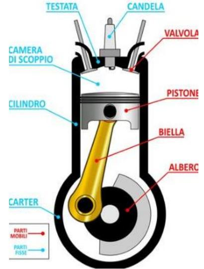
Sezione trasversale di un motore alternativo (macchina volumetrica alternativa termica motrice).
