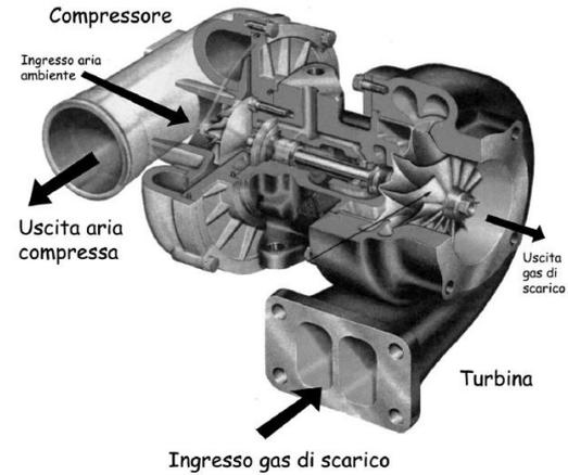
Turbocompressore (turbo-gruppo o turbo o turbocharger).
