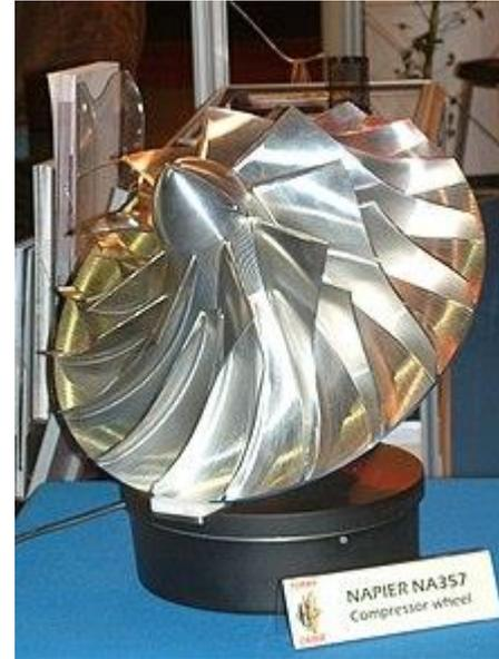
Compressore radiale (macchina termica operatrice dinamica).
