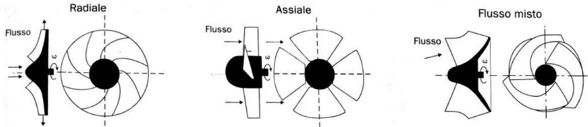
Vista della girante di una turbomacchina nel piano meridiano e nel piano ortogonale all'asse di rotazione.
