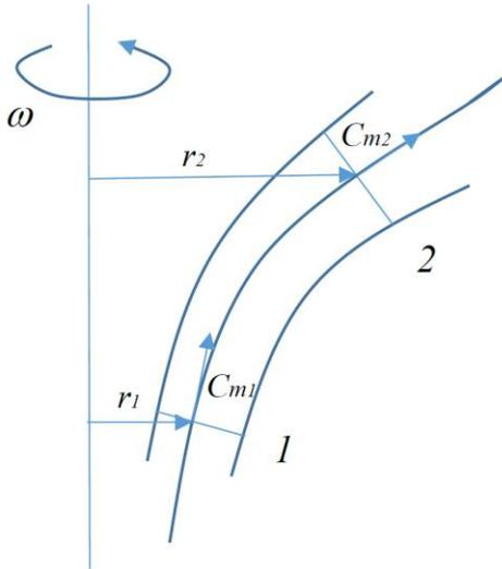
Consideriamo una unità di massa di fluido che attraversi una generica turbomacchina, la cui sezione meridiana è rappresentata in figura.
