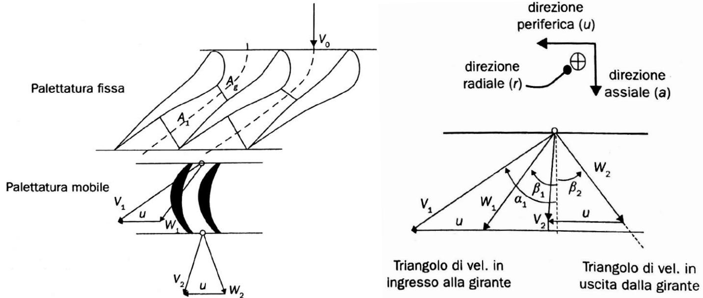
Palettature di statore e rotore e triangoli di velocità dello stadio di una turbina assiale.
