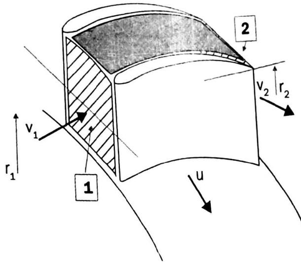
Canale del rotore delimitato da due pale successive, dove sono evidenziate le sezioni di ingresso 1 e uscita 2.
