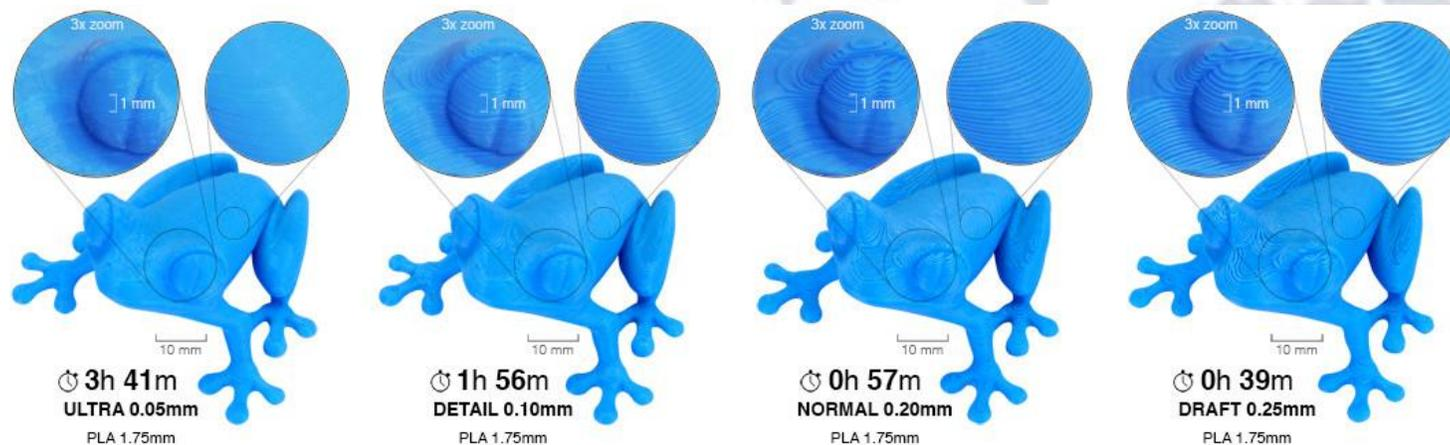
Lo slicing è una operazione critica perché determina le caratteristiche superficiali dell'oggetto finito. Questa operazione può essere di tipo **costante** oppure **adattativo** quando lo spessore delle slice (*fette*) è variabile e lo si sceglie in funzione della curvatura della superficie al fine di adattare meglio la geometria finale, riducendo l'effetto *a gradino*.
