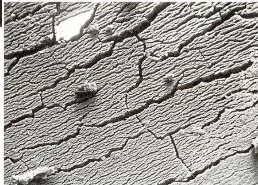
POM 100h ambiente di test UV (SEM)
