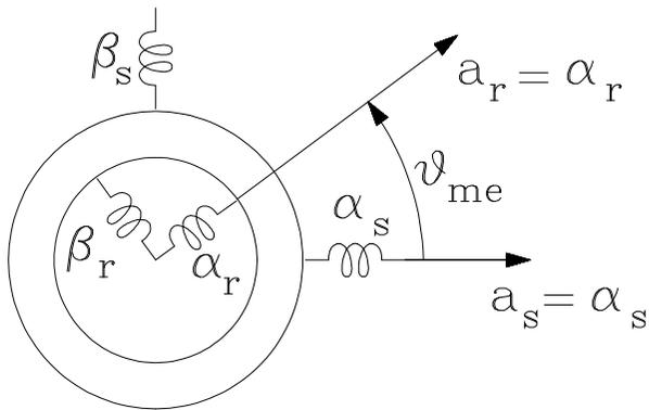
$$v_{\alpha s} = R_s i_{\alpha s} + \frac{d\lambda_{\alpha s}}{dt}$$
