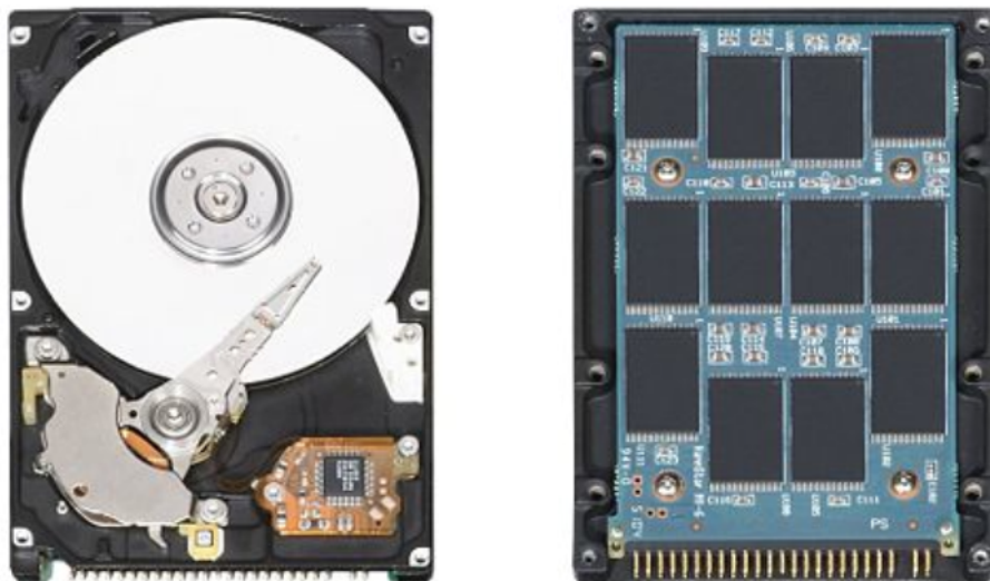
Figura 7.18: Confronto tra un disco rigido elettromeccanico e la corrispondente versione SSD a stato solido, basata sulle memorie NVM
