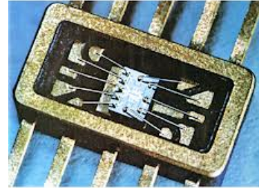
(c) Struttura interna di un circuito integrato per montaggio superficiale
