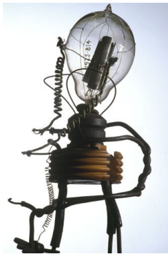
(a) Diodo a vuoto di Fleming (1904)
