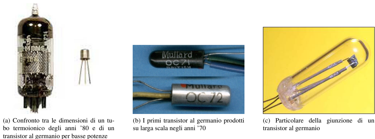
Figura 1.18: I primi transistor prodotti in larga scala negli anni '70 a confronto con la tecnologia dei tubi a vuoto, oramai al tramonto
