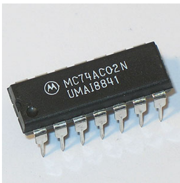
(a) Contenitore per un circuito integrato con quattro porte logiche di tipo NOR
