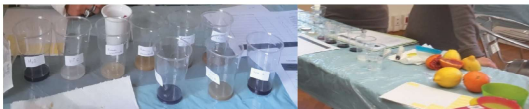
Figura 1. La sperimentazione dell'attività 2: la misura semiquantitativa del contenuto di Vitamina C
