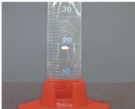
Figura 4. Sfera di alginato con lievito immobilizzato in H_2O_2 : la sfera sale spinta dalle bolle di gas.
