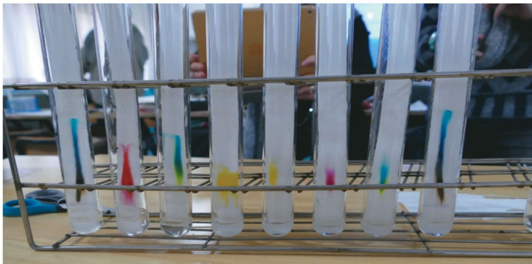
Figura 1. Cromatografia su carta di pennarelli ad acqua di diverso colore, da destra il secondo, il terzo e il quarto sono colori primari
