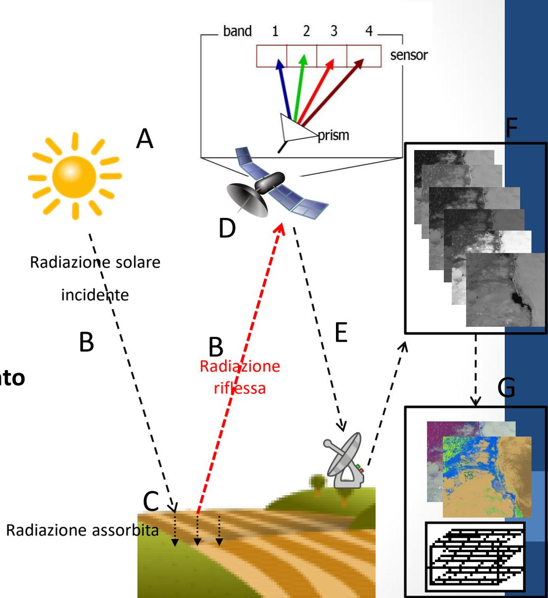
Il telerilevamento si basa sulla rilevazione e registrazione dell'energia elettromagnetica. Lo spettro delle onde elettromagnetiche può essere suddiviso in regioni, a seconda della lunghezza d'onda.
