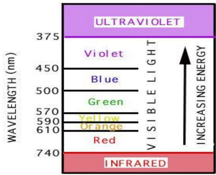
Il telerilevamento si basa sulla rilevazione e registrazione dell'energia elettromagnetica. Lo spettro delle onde elettromagnetiche può essere suddiviso in regioni, a seconda della lunghezza d'onda.
