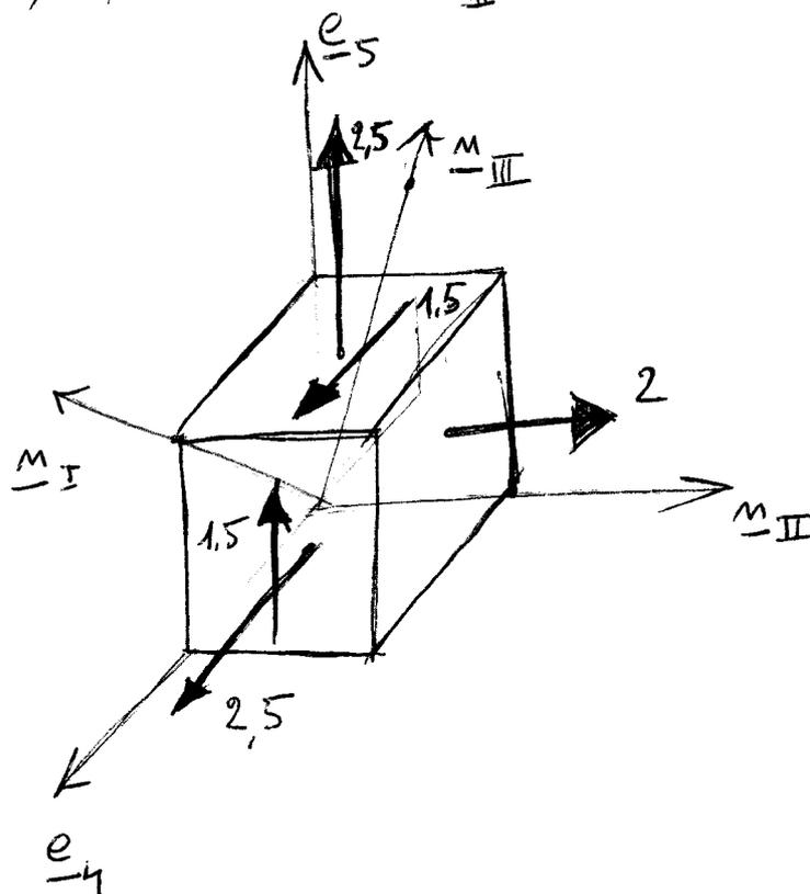
Nel sistema  $\underline{e}_4, \underline{m}_{II}, \underline{e}_5$  il tensore degli sforzi  $\underline{\sigma}$
