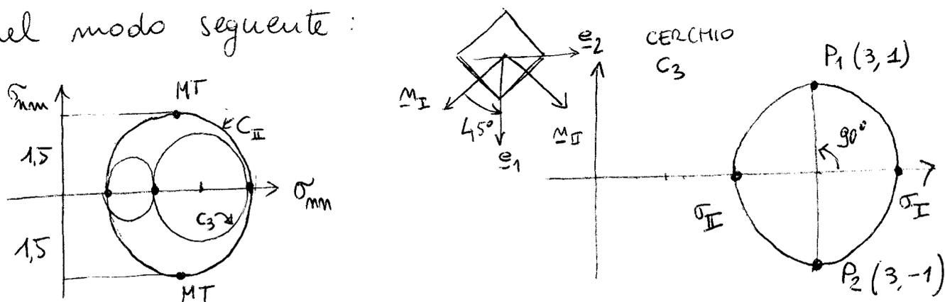
Essendo  $e_3$  già direzione principale il cerchio  $C_3$  (individuato da  $\sigma_{II} = 2$  e da  $\sigma_{II} = 4$ ) descrive tutti gli stati tensionali relativi alle giaciture aventi normali contenute nel piano  $e_1 - e_2$  o, equivalentemente,  $\underline{M}_I - \underline{M}_{II}$ .
