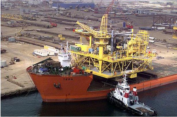
Figura 7 - Dockwise ship carica da terra un topside
