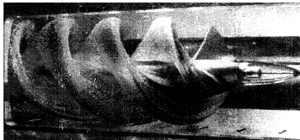
Figura 6.30. Elica in regime supercavitante
