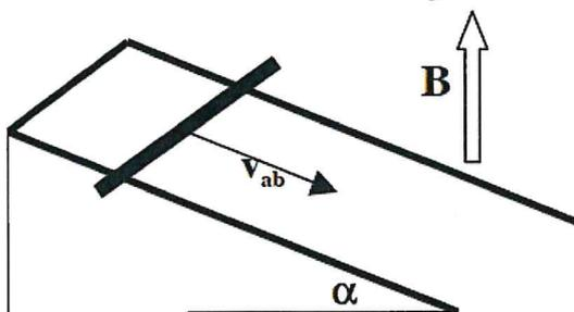
2. In un piano inclinato di angolo  $\alpha = 30^\circ$  sono poste due rotaie parallele di resistenza elettrica trascurabile, connesse elettricamente tra loro alla sommità e distanti  $L = 10$  cm. Su di esse può scorrere senza attrito una sbarretta conduttrice **ab**, di massa  $m = 10.0$  g e resistenza elettrica  $R = 0.10 \Omega$ . Il tutto è immerso in un campo magnetico uniforme e costante, diretto
