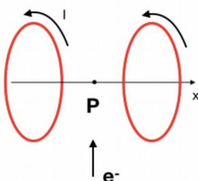
2. Un elettrone ( $m_e=9.11 \times 10^{-31}\text{ kg}$ ) viene sparato tra due "bobine di Helmholtz" (Fig. 2), due bobine coassiali di  $N=50$  spire l'una, di raggio  $R=5.40\text{ cm}$ , separate da una distanza  $d=2R$  ed attraversate, nello stesso senso come in figura, da una corrente  $I=1.2\text{ A}$ . La velocita` dell'elettrone e`  $v=1.43 \times 10^8\text{ m/s}$ .
