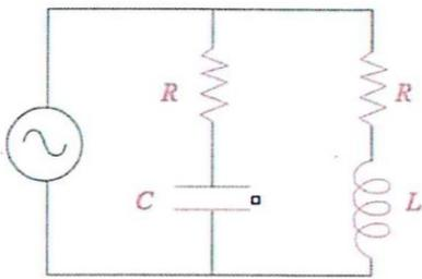
3. Un circuito e` composto dal parallelo di un RC serie e di un RL serie, con  $R=12.0\Omega$  uguale per le due resistenze,  $C=120\mu F$  e  $L=16.0mH$ . Viene attraversato da una corrente alternata di  $\nu=80.0Hz$  e  $V_{eff}=20.0V$ .
