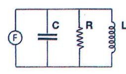
3. Si consideri un circuito RLC in parallelo a corrente alternata, con  $L=0.50\,H$ ,  $R=100\,\Omega$ ,
