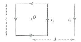
2. Il sistema raffigurato nella figura qui a lato e` composto da una bobina quadrata con N=10 spire, di lato l=5 cm, in cui scorre una corrente  $i_1$ =4A, il cui centro geometrico O dista d=12.5 cm da un filo di lunghezza indefinita in cui scorre una corrente  $i_2$ =1A.
