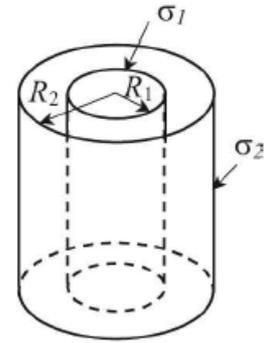
Data la simmetria della distribuzione di carica possiamo calcolare il campo elettrostatico applicando il teorema di Gauss. Il campo è radiale ed assume lo stesso modulo su superfici cilindriche coassiali con la distribuzione di carica assegnata. Assumendo come superficie di Gauss  $\Sigma$  una di tali superfici cilindriche di altezza arbitraria  $h$  e di raggio  $r$ , si ottiene che il flusso uscente del campo  $\mathbf{E}$  è dato da:
