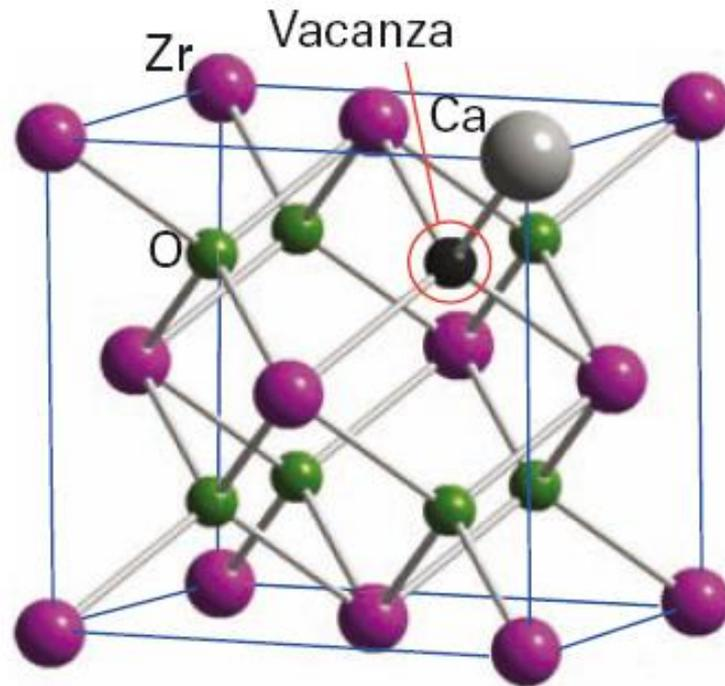
$\text{Ca}^{2+}$  al posto di  $\text{Zr}^{4+}$  in  $\text{ZrO}_2$  genera una vacanza di ossigeno
