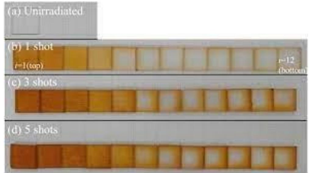
*NaCl esposto a vapori di Na diventa arancio a causa della formazione di centri-F o bombardamento di fasci di elettroni*
