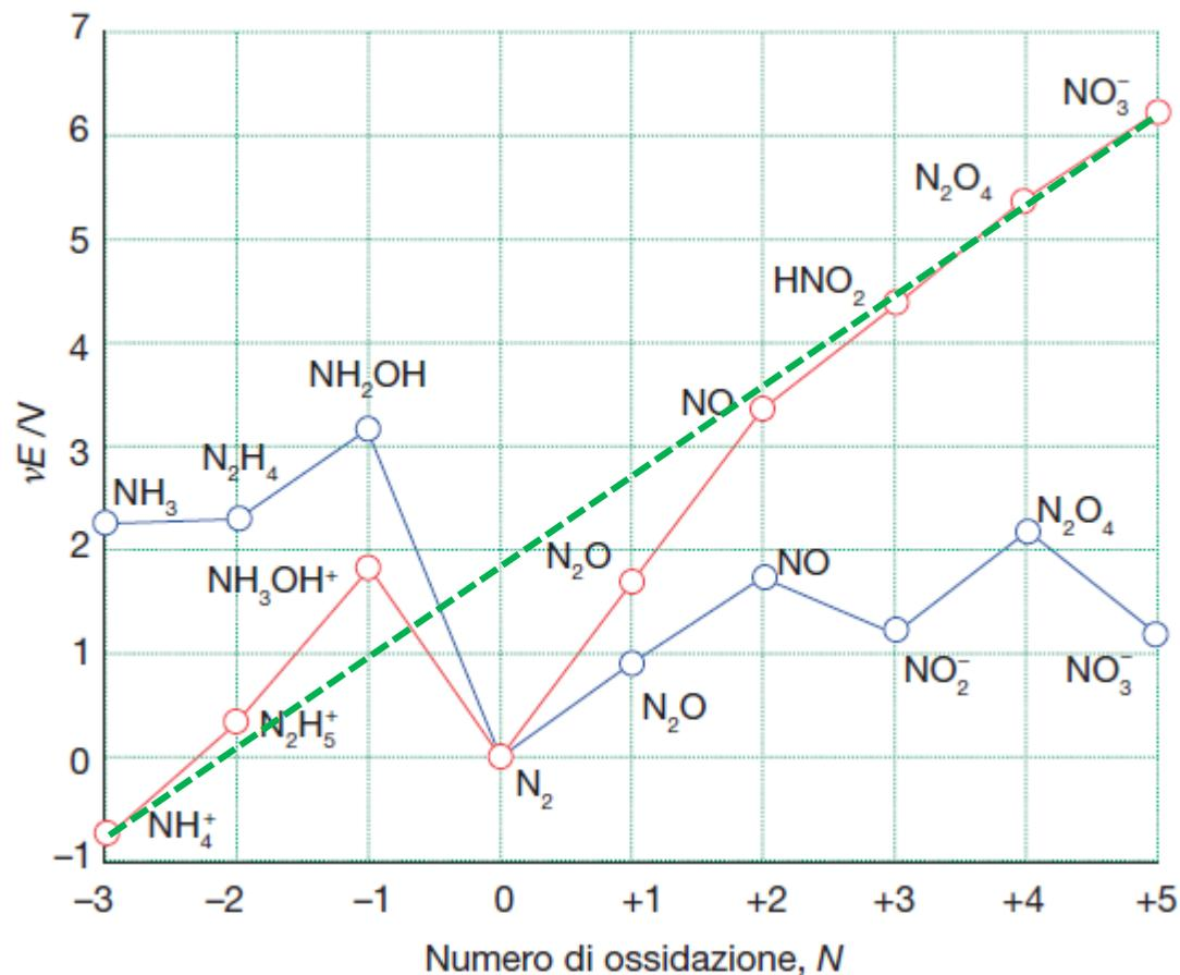
L'azoto in  $\text{NH}_4\text{NO}_3$  ha due ioni con numeri di ossidazione  $-3$  ( $\text{NH}_4^+$ ) e  $+5$  ( $\text{NO}_3^-$ ). Poiché  $\text{N}_2\text{O}$  sta sotto alla retta che congiunge  $\text{NH}_4^+$  a  $\text{NO}_3^-$ , la loro comproporzione è un processo spontaneo.
