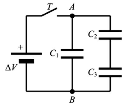
Situazione iniziale: l'interruttore  $T$  è chiuso i condensatori  $C_2$  e  $C_3$  sono collegati in serie, la loro capacità equivalente che è in parallelo con  $C_1$  è la seguente:
