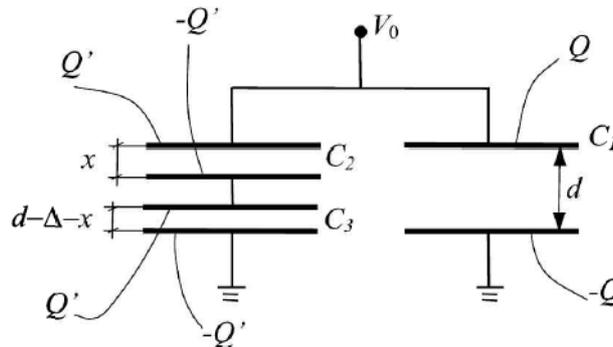
in questa situazione si osserva il formarsi di un sistema di 3 condensatori:
