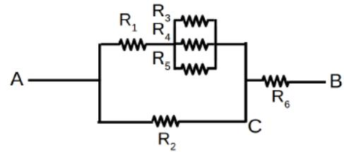
Ricordando le regole per combinare le resistenze in serie ed in parallelo
