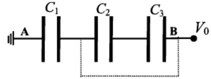
I tre condensatori sono in serie, per cui, detta  $Q$  la carica presente sulle armature dei condensatori, deve aversi:
