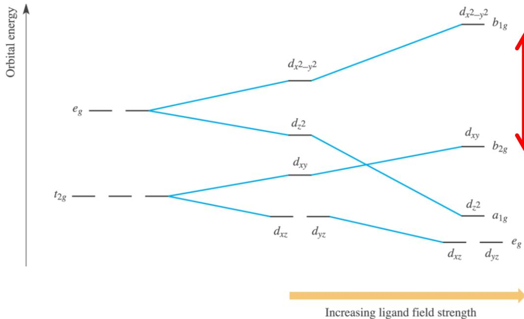
*I complessi planari quadrati sono particolarmente comuni per gli ioni con configurazione elettronica  $d^8$ : Ni(II), Pd(II), Pt(II), Rh(I), Ir(I), Au(III)*
