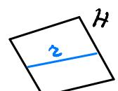
$$3.3) r \parallel H \quad \text{e} \quad r \cap H = \emptyset \Leftrightarrow \operatorname{rg} \begin{pmatrix} a & b & c \\ a' & b' & c' \\ a'' & b'' & c'' \end{pmatrix} = 2 \quad \text{e} \quad \operatorname{rg} \begin{pmatrix} a & b & c & d \\ a' & b' & c' & d' \\ a'' & b'' & c'' & d'' \end{pmatrix} = 3$$
